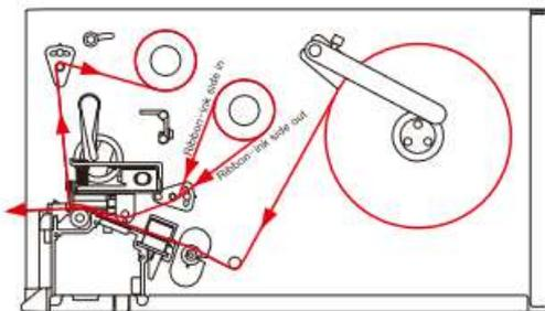
1. Поднимите крышку принтера. Поднимите печатающий модуль. Установите риббон на вал для риббона, а втулку – на вал для использованного риббона.
