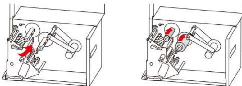
2. Протяните риббон через печатающий модуль. Ориентируйтесь на схему на задней стенке принтера. Оберните край ленты вокруг пустой втулки. Подкрутите колесо для надежной фиксации.
