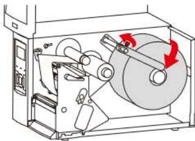
3. Протяните этикет-ленту через печатающий модуль. Для RFID также необходимо протянуть ленту под RFID антенной после прохождения через печатающий модуль.
